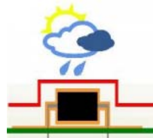
Elektronička tiskana pločica s konformnim premazom (dostupna također i kao rezervni dio)
